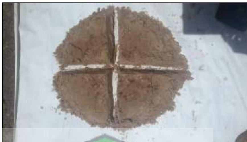
Gambar 4.3 Preparasi Sampel dengan Metode Coning and Quartering
